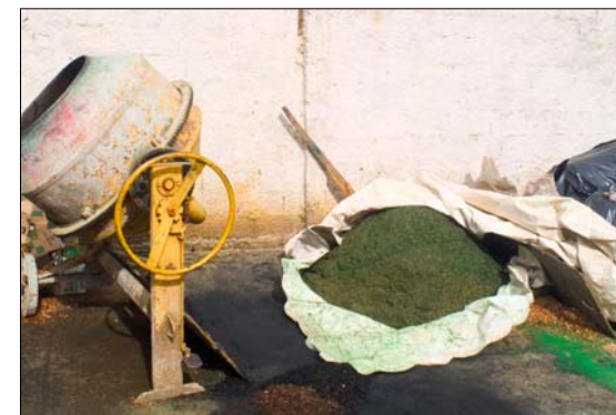
Figura 41 – Betoneira e serragem tingida. Equipamento pesado para tingimento da serragem utilizada no tapete da Paróquia da Conceição. (2009).
