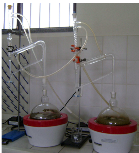
Figura 26: Hidrodestilação em aparelho de Clevenger. Foto: SILVA, 2009
