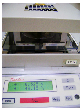
Figura 28: Teor de umidade presente na amostra detectado pelo Determinador de Umidade Marte®. Foto: SILVA, 2009.
