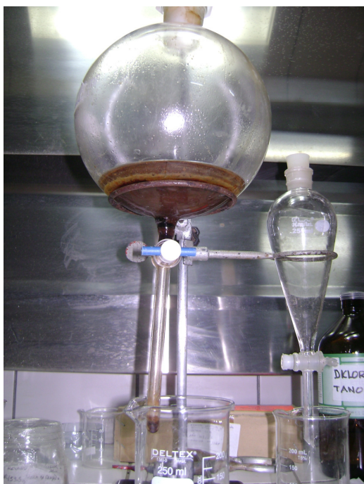
Figura 04: Método de fracionamento por partição do extrato bruto do caule da Cratylia hypargyrea .
