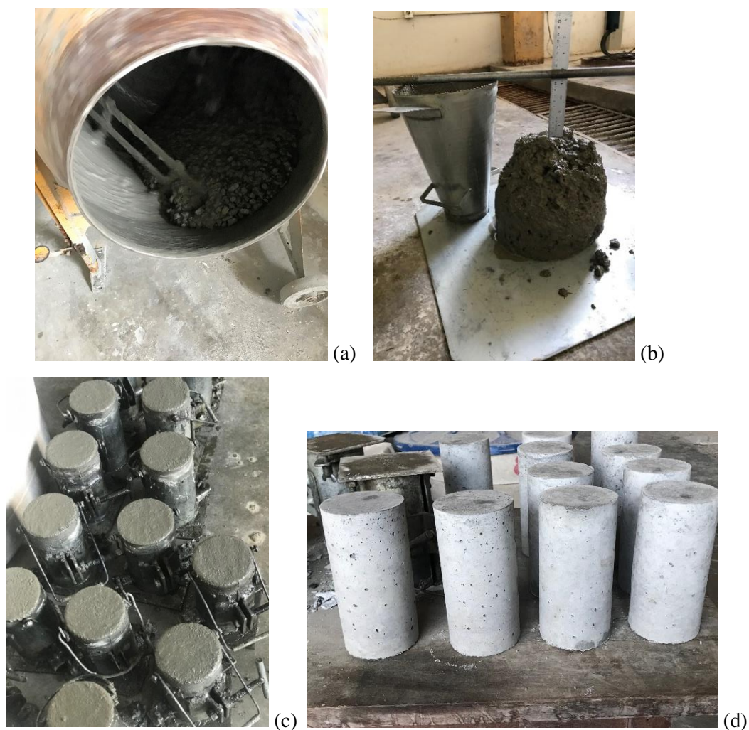
Figura 21 Produção dos concretos. a) Mistura dos componentes do concreto em betoneira, b) Ensaio de abatimento pelo tronco de cone, c) Corpos de prova moldados em forma cilíndrica 100 mm x 200 mm e d) Corpos de prova desmoldados após 24 horas
