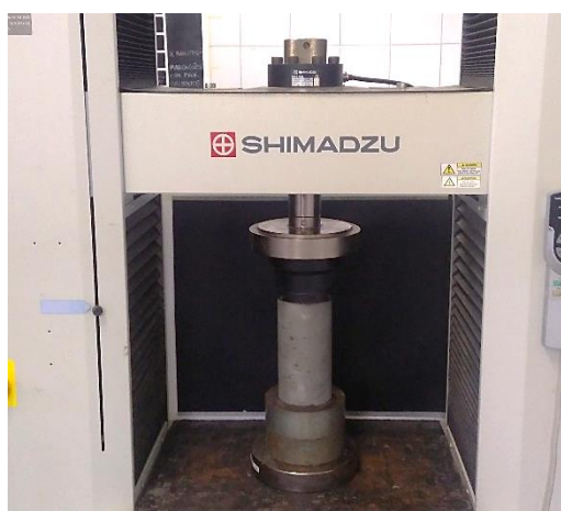
Figura 30 Ensaio de fissuração
