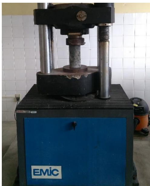
Figura 31 Ensaio de resistência à compressão axial
