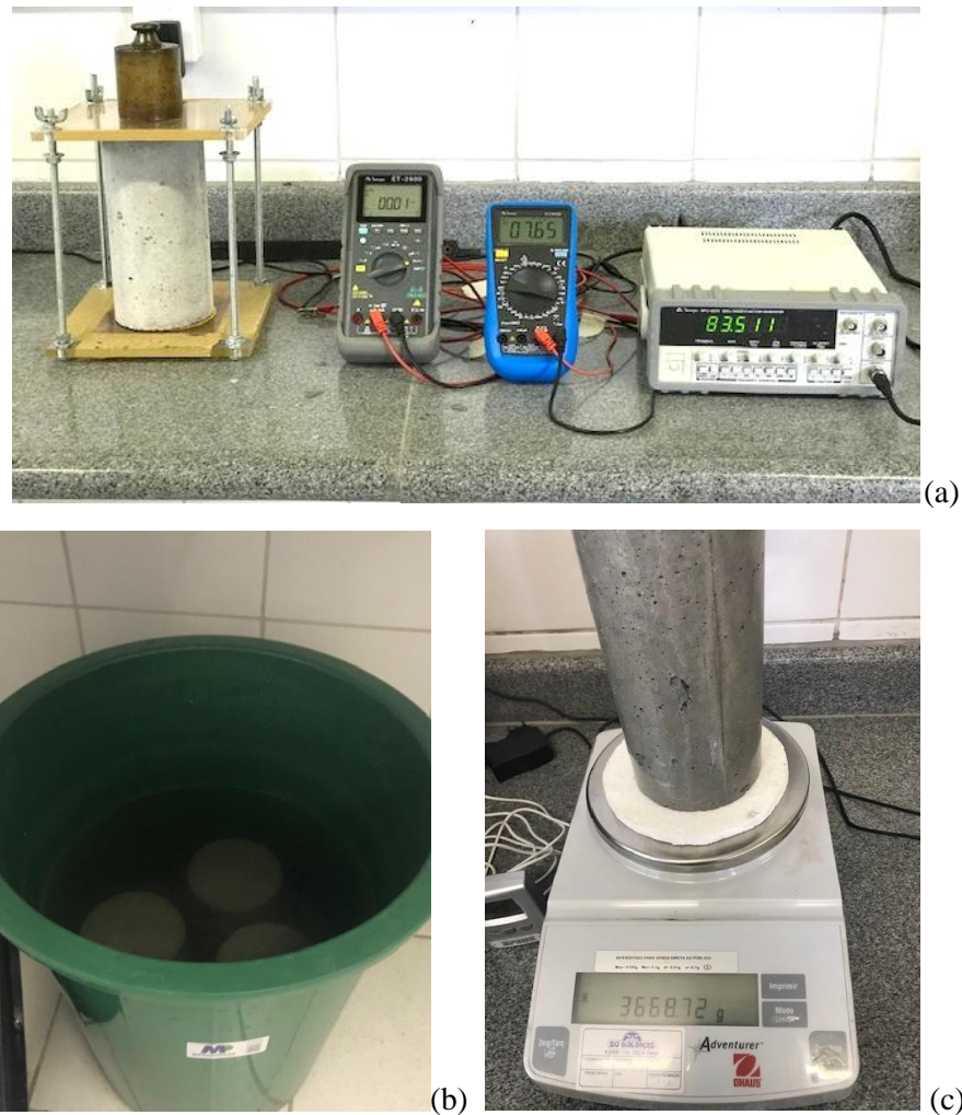
Figura 26 Ensaio de teor de umidade. a) Leitura corpo de prova seco em estufa, b) Corpos de prova imersos em água potável, c) Momento da pesagem da massa do corpo de prova.
