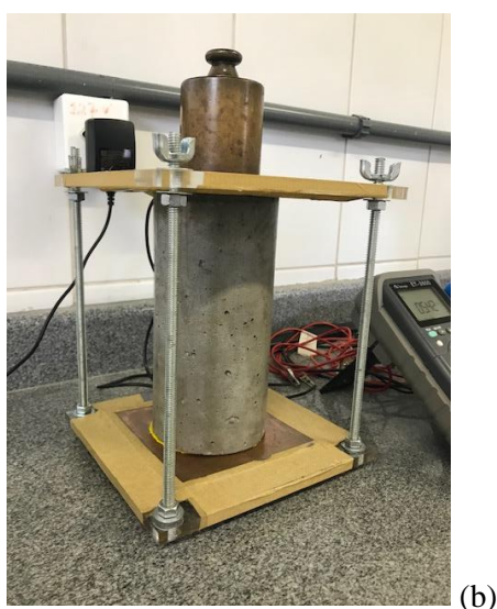
Figura 23 Medida da resistividade elétrica. a) Equipamento confeccionado para medições da resistividade b) Corpo de prova no momento da medição da resistência
