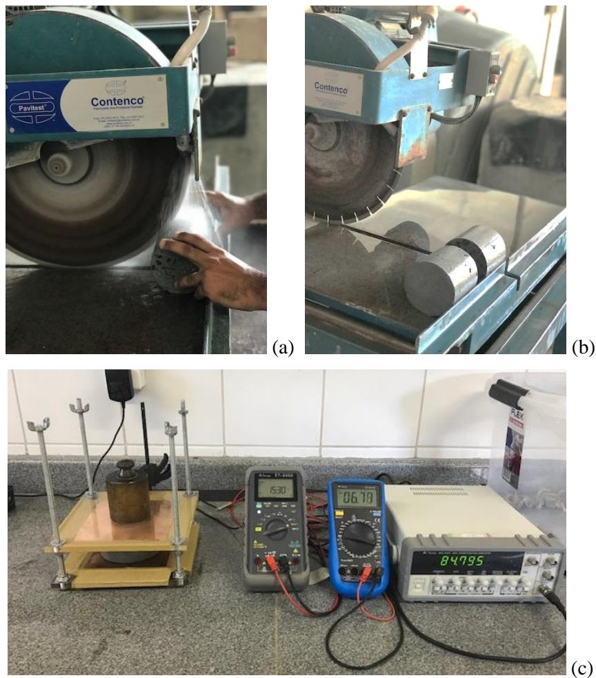
Figura 27 Ensaio dimensão da amostra. a) Momento do corte do corpo de prova, b) Corpo de prova seccionado ao meio (100x100 mm), c) Medição do corpo de prova (100x50 mm).
