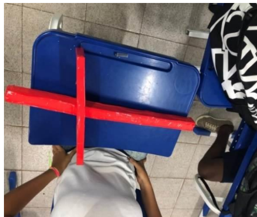
Figura 23: Balestilha com isopor
