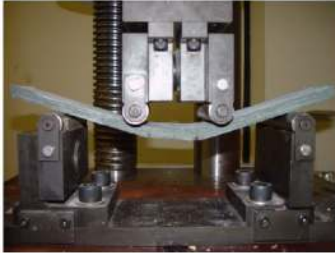
Figura 2.24 – Ensaio de flexão com quatro pontos de uma placa compósita de matriz cimentícia reforçada com fibra de sisal (LIMA, 2004)
