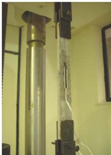
Figura 3.4 – Configuração do ensaio de tração direta em laminados com 400 mm (LIMA, 2004)
