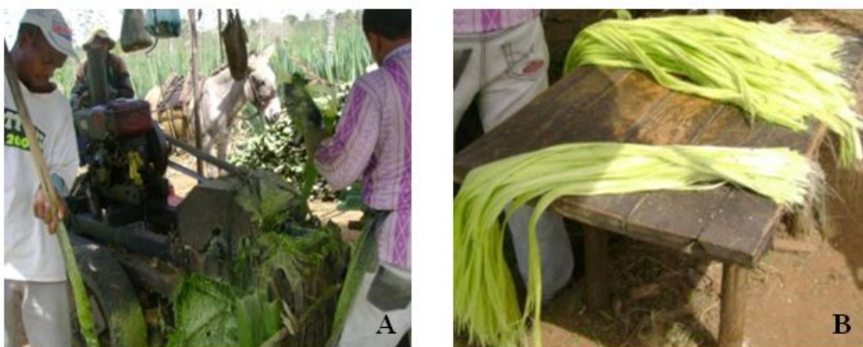
Figura 4: Desfibramento de folhas de A. sisalana (A) e Fibras (B), Valente, Bahia.
