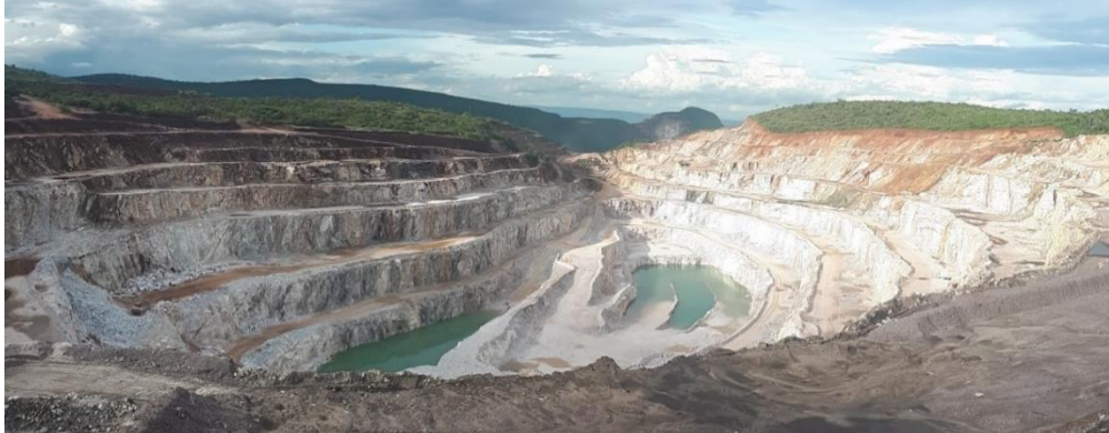
Figura 2 – Lavra por bancadas (Open Pit), Mina de Cabezeira-RHI Magnesita
