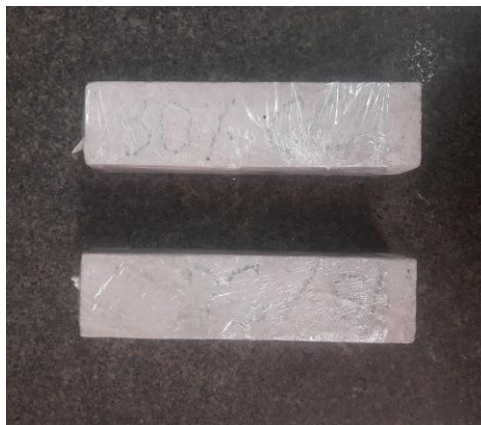
Figura 32 Corpos de prova selados com filme plástico para a realização do ensaio de absorção por capilaridade
