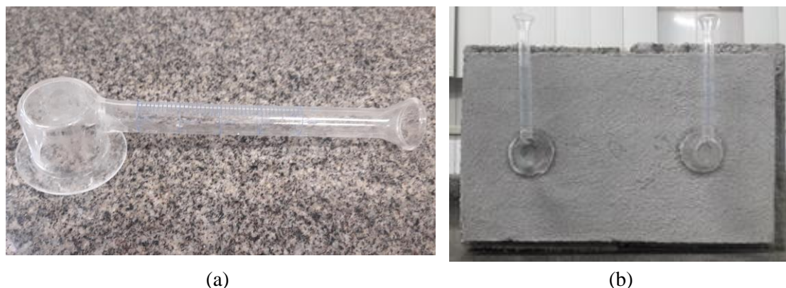
Figura 34 Ensaio de permeabilidade pelo método do Cachimbo: a) Instrumento utilizado para a realização do ensaio; b) Cachimbos fixados na superfície da amostra
