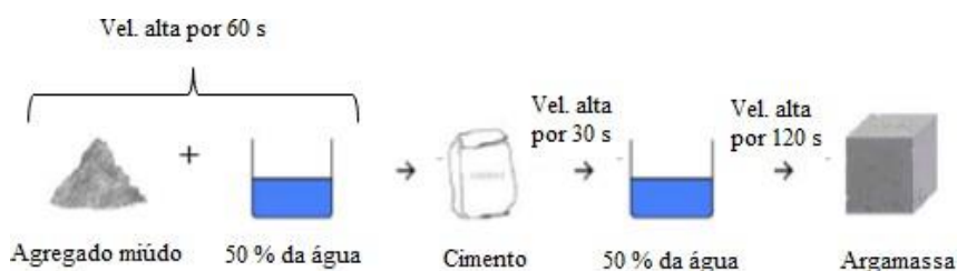
Figura 13 Representação esquemática do método MDE (Fonte: SILVA NETO; LEITE, 2018)
