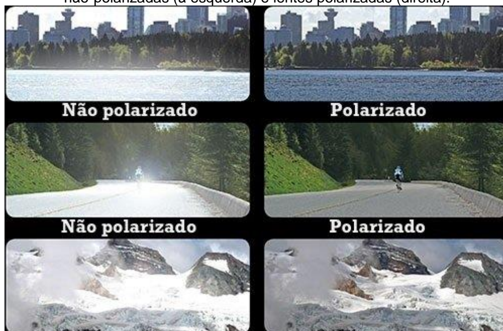
Figura 12 - Comparativo da observação de ambientes bem iluminados por meio de lentes não-polarizadas (à esquerda) e lentes polarizadas (direita).
