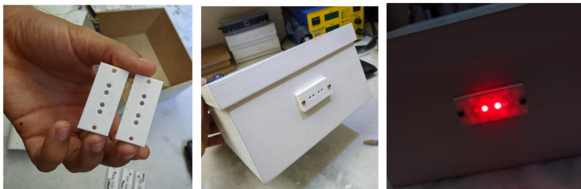
Figura 64 – Um dos protótipos testados durante a pesquisa. Investigando a possibilidade de utilizar LEDs de diferentes comprimentos de onda no roteiro.
