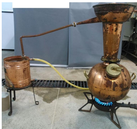
Figura 6 — Alambique de cobre utilizado para a destilação da cachaça produzida em escala piloto.
