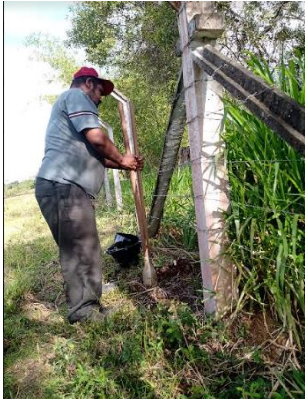
Coleta de solo na área externa da fábrica.
