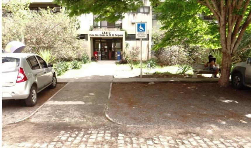
Figura 27 - Rota 5: Rampa de acesso ao LABIO e estacionamento reservado para pessoas com mobilidade reduzida, de piso não pavimentado (pedra brita) e sem acesso direto por rampa.
