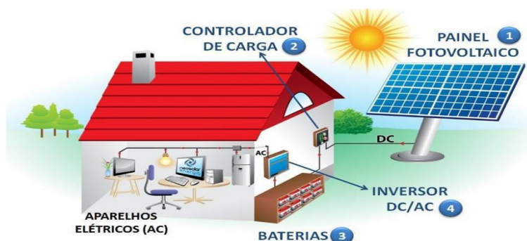
Figura 32 – Sistema fotovoltaico off grid (fora da rede)
