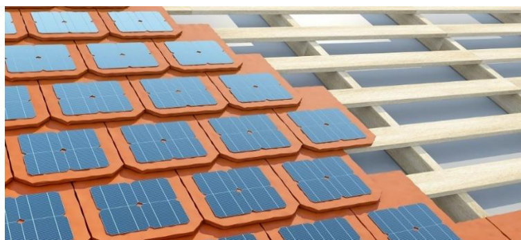
Figura 13 – Instalação de telhas fotovoltaicas em residências
