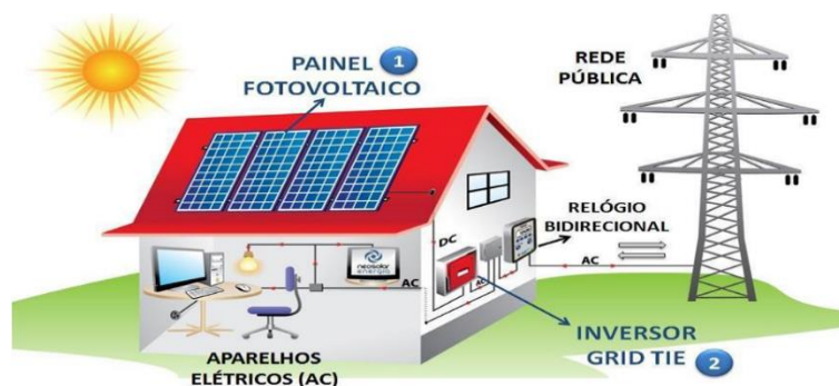
Figura 31 – Sistema fotovoltaico on-grid (na rede)
