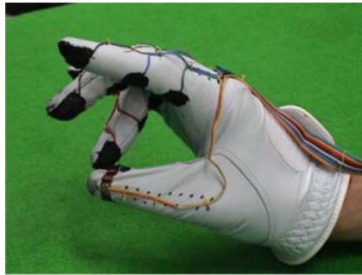
Figura 3.6: Dispositivo de escrita em forma de luva.
