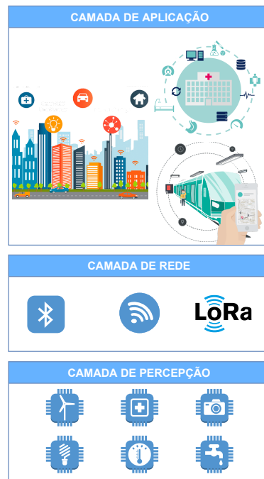
Figura 2.1: Arquitetura de Três Camadas - IoT.
