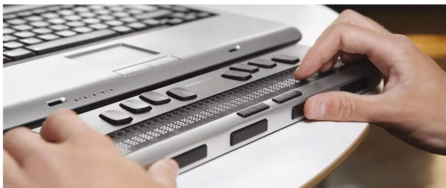
Figura 2.5: Linha Braille ( Display Braille ) conectada ao computador - Fonte: https://oampliadordeideias.com.br/como-funciona-uma-linha-braille/ .
