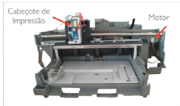
Figura 3.4: Protótipo de impressora Braille sobre estrutura de impressora HP Deskjet 610C com modificação do sistema de impressão - Fonte: Fernandes et al. (2016).
