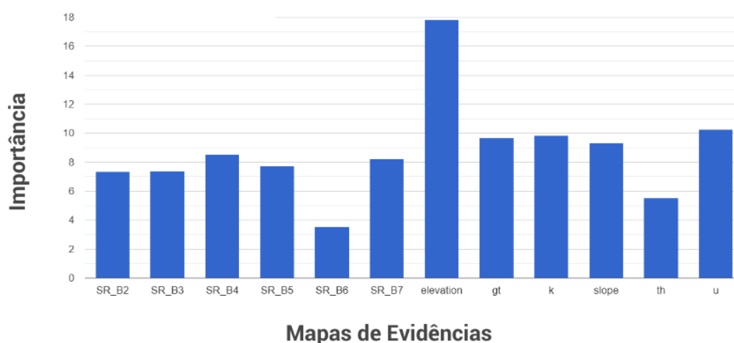
Figura 20 – Gráfico da importância relativa das variáveis utilizadas como mapas de evidência na geração do modelo de potencial mineral de bauxita.
