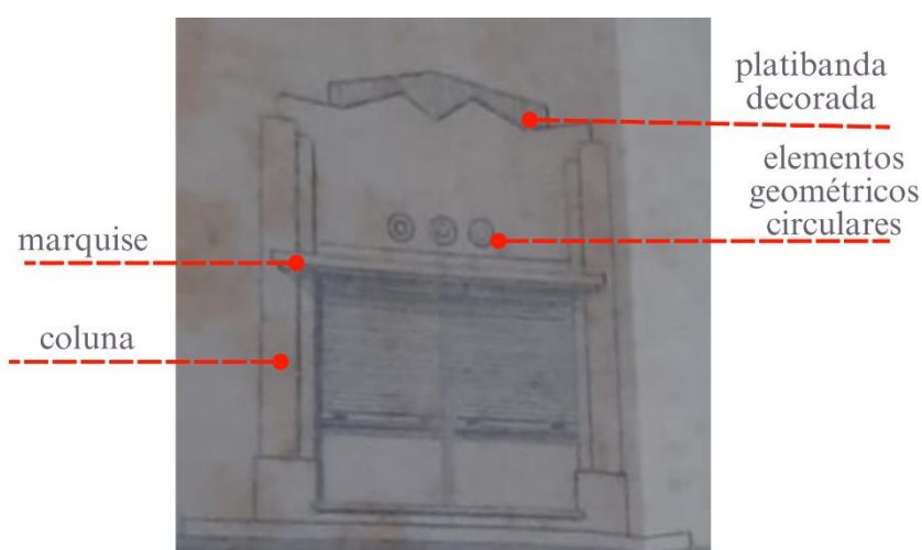
Figura 41 -Planta técnica da fachada comercial nº 46, estilo Art Déco na rua Sales Barbosa, datada de 1960, responsável técnico Eraldo Gama Lobo
