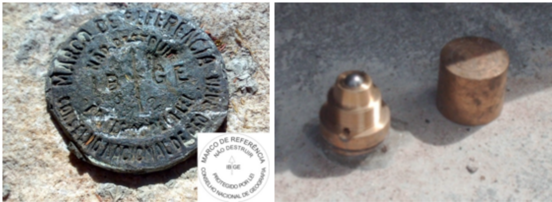
Figura 2.6: Outros modelos de RRNN encontrados no entorno da Estação Maregráfica. Fonte: Acervo IBGE
