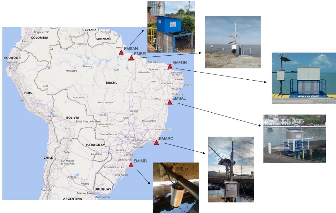
Figura 3.16: Estações Maregráficas controladas pelo IBGE e objeto de estudo da pesquisa. Fonte: (JUNIOR et al., 2025)
