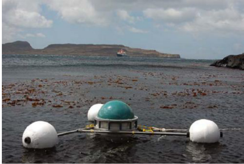
Figura 2.9: Boia GPS usada durante a campanha de Kerguelen. Fonte: (FUND et al., 2013).
