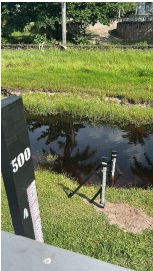
Figura 4 instalação régua nível Foto própria autoria /2026
