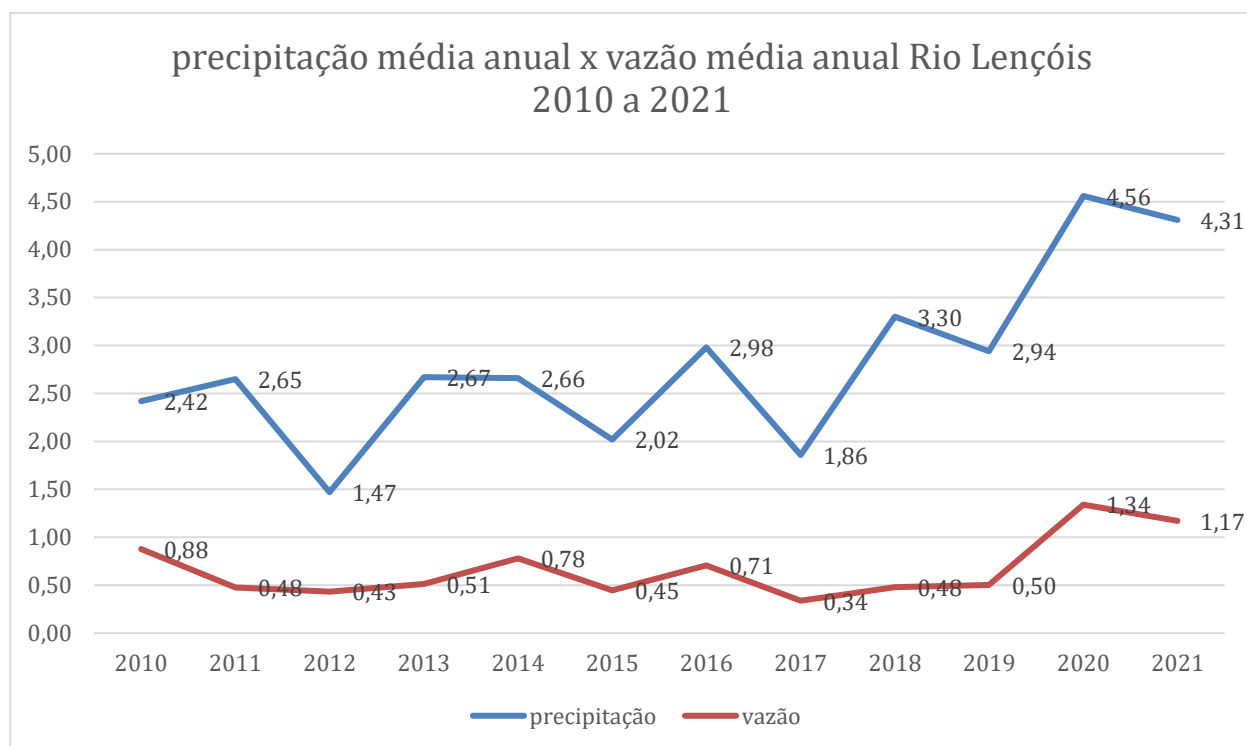
Figura 16: Avaliação temporal das médias anuais de pluviosidade e vazão para o período de 2010 a 2021.
