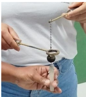
Figura 2 - Anel de Gravesande e sua esfera sendo aquecida
