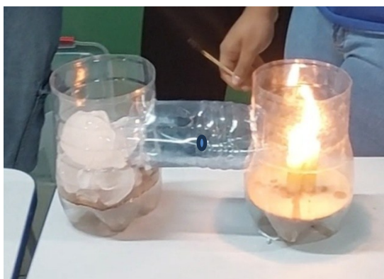
Figura 7 - Estrutura utilizada para o experimento de Correntes de convecção nos gases
