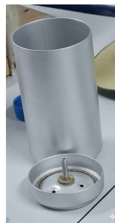
Figura 3 – Detalhe do cilindro quente construído com lata de alumínio e o cabeçote
