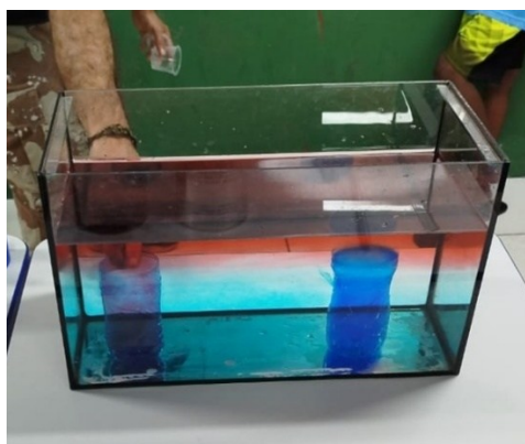
Figura 6 - Estrutura utilizada para o experimento de Correntes de convecção nos líquidos
