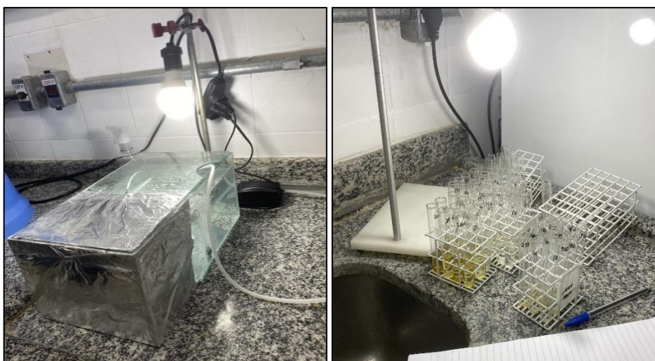
Figura 14. Sistema de realização do teste de letalidade da Artemia salina
