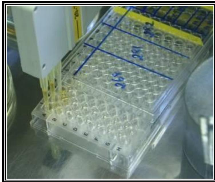
**FIGURA 16.** Determinação da CIM utilizando-se uma pipeta automática multicanal. Foto: Vasconcellos- Neto (2009).
