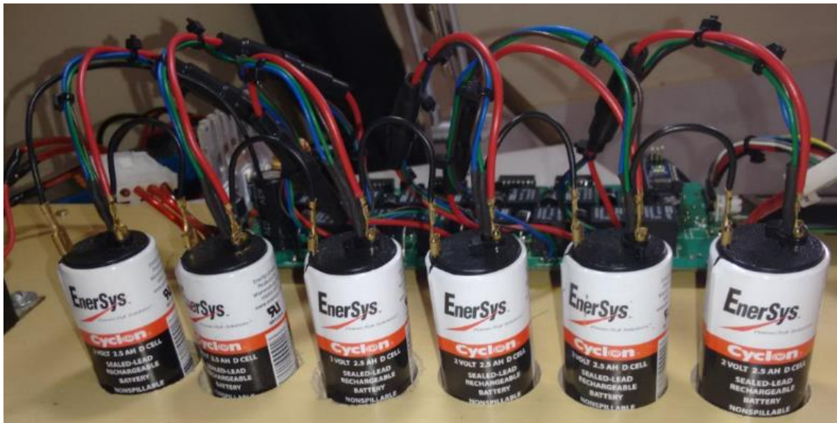
Figura 45: Ligação das células de bateria em série.
