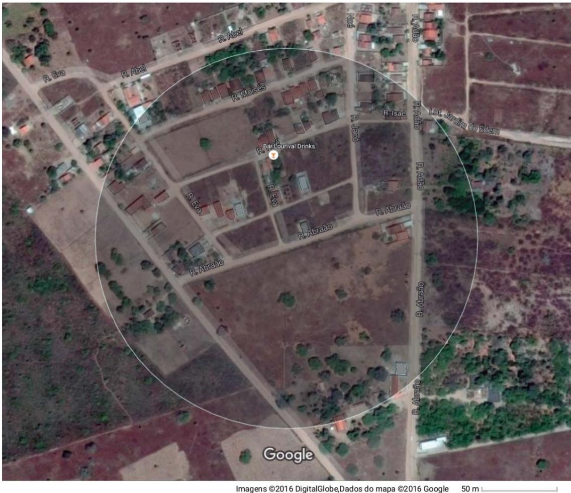
Figura 4.5: Marcação das construções para conversão em KML e posterior cálculo da área construída no sítio
