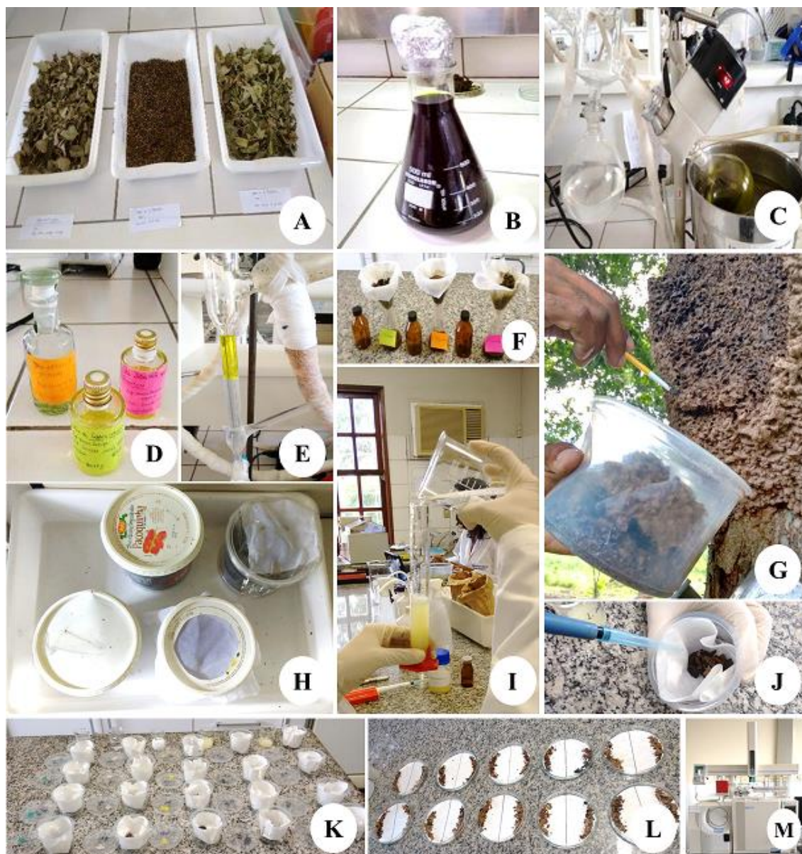
Figura 1: Fases do método experimental utilizado: A) Folhas secas em temperatura ambiente B) Maceração dos extratos (72hs) através do metanol, para a obtenção do extrato metanólico; C) Concentração do extrato em evaporador rotatório (rota evaporador); D) Armazenamento dos óleos essenciais em frascos de vidro; E) coluna de óleo obtida por arraste á vapor no aparelho de clevenger; F) Obetnção dos extratos aquosos G) Coleta dos cupins da espécie N. corniger em ambiente natural da cidade de Feira de Santana; H) Armazenamento em potes plásticos de fragmentos da colônia; H) Diluição dos óleos essências em diferentes concentrações; I) Procedimento experimental para a avaliação inseticida; J) Aplicação dos OE's contra Nasutitermes corniger ; K) Deliniamento experimental utlizado para a avaliação inseticida; L) experimento para a avaliação da atividade repelente; M) CG-MS , utlizado para a avaliação qualitativa da composição química dos óleos essências, Feira de Santana , Bahia , Brasil. Fotos: SANTOS, D.R. dos, 2017
