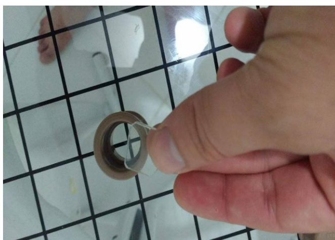
Figura B.6: Luva e o pedaço de CD sem a película no formato quadrado.
