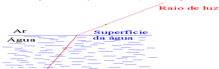
Figura 3.3: Refração da luz na superfície da água.
