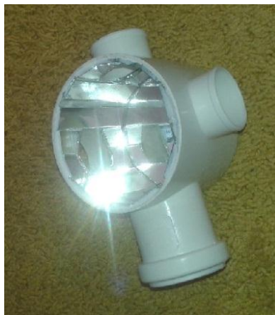
Figura 1: Ralo sifonado revestido de espelho
