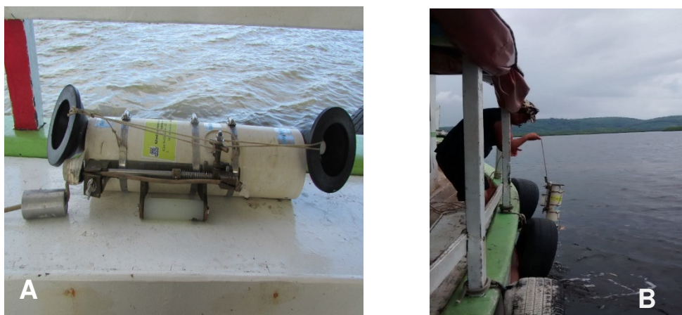
Figura 9. Em (A) Garrafa de Van Dorm, e em (B) Procedimento de coleta da água no Estuário para medida da salinidade.
