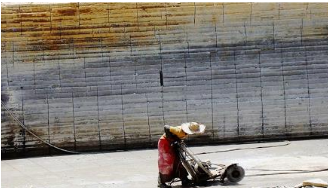
Figura 5 - Processo de lavra semimecanizado (Fonte: MENDES FILHO, 2009).
