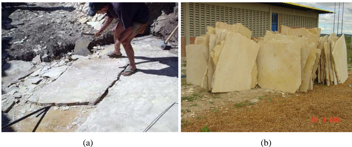
Figura 4–Lavra rudimentar: a) processo de extração (Fonte: BASTOS, 2014); b) aspecto das placas extraídas (Fonte: ADEODATO; VIDAL, 2005)
