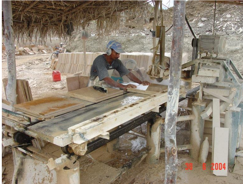
Figura 7 - Processo de serragem da pedra Cariri (Fonte: ADEODATO; VIDAL, 2005).
