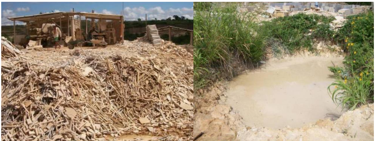
Figura 9- Rejeitos de serragem: a) na forma de lascas e aparas; b) na forma fluida (Fonte: SUASSUNA et al. , 2012).
