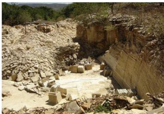
**Figura 28** Frente de lavra obstruída pelos rejeitos do processo produtivo da Pedra Cariri (Fonte: CASTRO, 2009)
