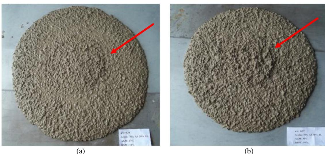
**Figura 65** Comportamento do CAA (a/c 0,70) no ensaio de espalhamento durante o ajuste de agregado graúdo: (a) 27,0% de agregado graúdo; (b) 30,0% de agregado graúdo
