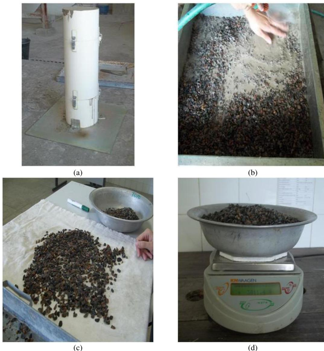
**Figura 53** Ensaio da coluna de segregação: (a) Equipamento preenchido com a amostra de CAA; (b) Lavagem da amostra sobre uma peneira com abertura da malha de 5mm; (c) Secagem superficial dos agregados graúdos; (d) Pesagem da amostra de agregado graúdo na condição saturado superfície seca (SSS)
