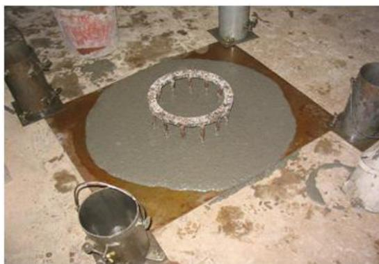
**Figura 14** Anel J em conjunto com o teste de espalhamento (Fonte: LEITE, 2007)
