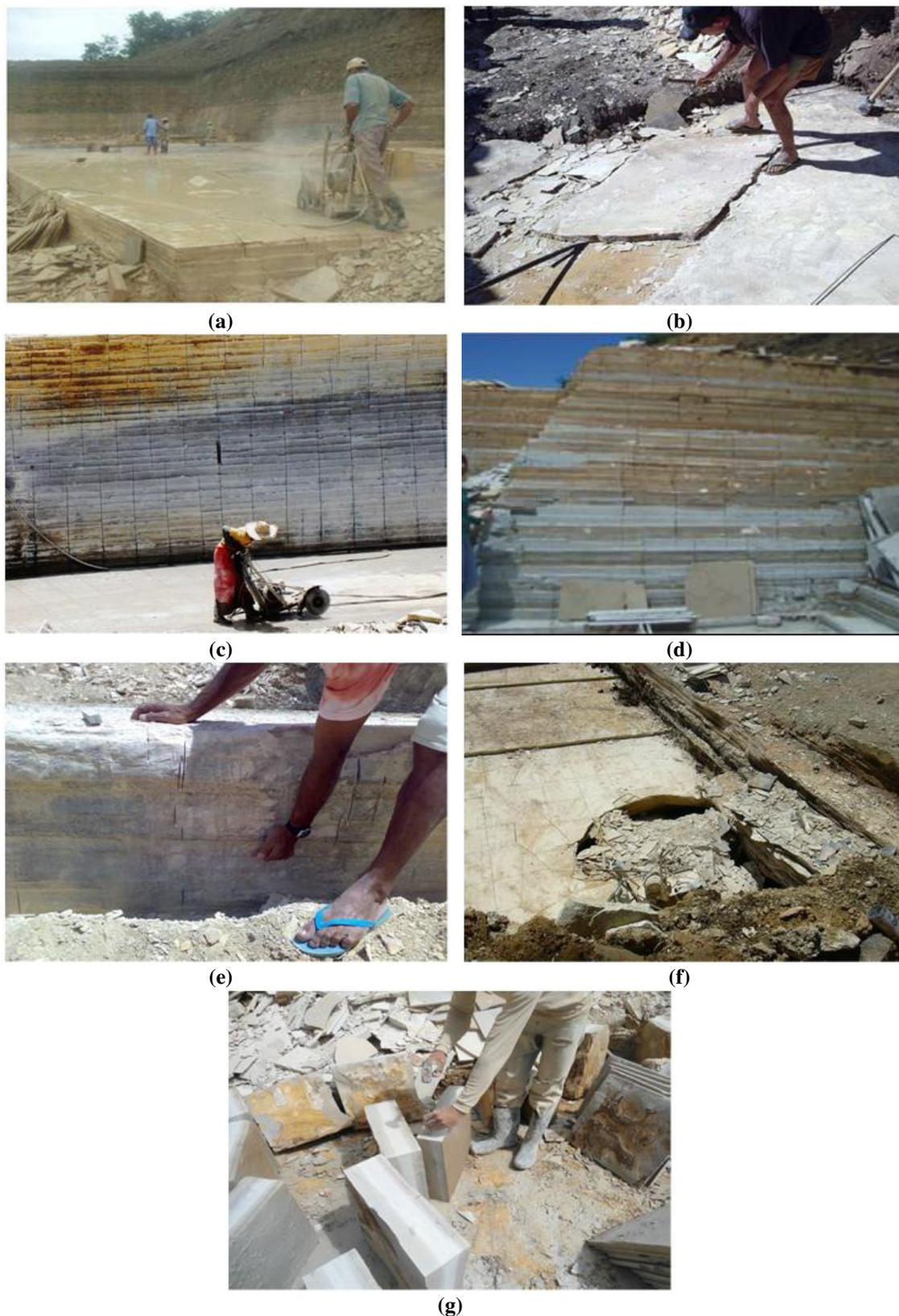
**Figura 29** Exploração de Pedra Cariri: (a) Área de lavra do calcário (Fonte: BASTOS, 2014); (b) Lavra manual (Fonte: VIDAL *et al.*, 2005); (c) Aspecto da pedreira com processo semimecanizado (Fonte: MENDES FILHO, 2009); (d) Aspecto da frente de lavra (Fonte: CLEMENTE *et al.*, 2016); (e) Camada de matrão (Fonte: CASTRO, 2009); (f) Caverna de dissolução cárstica (Fonte: CASTRO, 2009); (g) Desplacamento manual (Fonte BASTOS, 2014)
