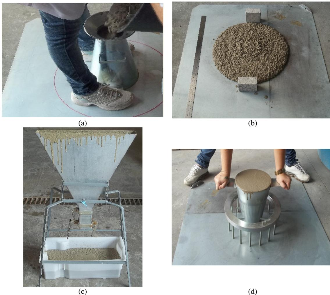
**Figura 51** Ensaios no CAA no estado fresco: (a) e (b) Determinação do espalhamento – Método do cone de Abrams; (c) Funil V; (d) Anel J
