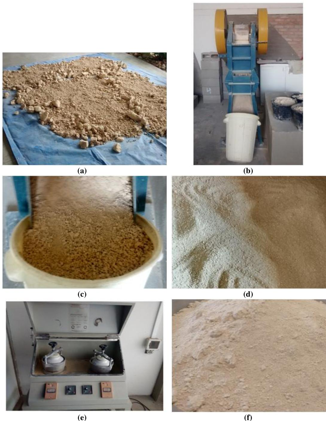
**Figura 42** Processo de beneficiamento do RSPC: (a) Aspecto do resíduo coletado retirado da baía do laboratório durante a secagem; (b) Britador de mandíbulas utilizado no primeiro destorroamento; (c) Aparência do resíduo após o destorroamento; (d) Aparência do resíduo após o peneiramento em malha de 4,8mm; (e) Moinho de bolas de eixo vertical excêntrico utilizado no segundo destorroamento; (f) Aspecto do RSPC após o beneficiamento
