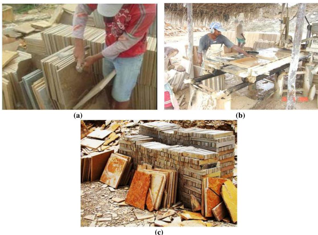
**Figura 30** Beneficiamento da Pedra Cariri: (a) Calibragem manual (Fonte: BASTOS, 2014); (b) Esquadrejamento na serraria (Fonte: CASTRO, 2009); (c) Local de estoque após o esquadrejamento (Fonte: MENDES FILHO, 2009)
