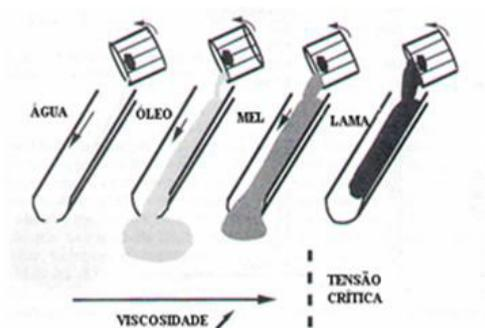
**Figura 3** Escoamento da água, óleo, mel e lama (Fonte: COUSSOT, 1997, citado por KIRYU, 2006)
