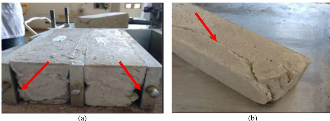
**Figura 61** Aspecto das argamassas autoadensáveis com substituição parcial do agregado miúdo por RSPC com relação a/c 0,46 após a moldagem: (a) argamassa dentro da forma, onde é possível verificar a falta de autoadensabilidade da mistura; (b) argamassa apresentando segregação em camadas
