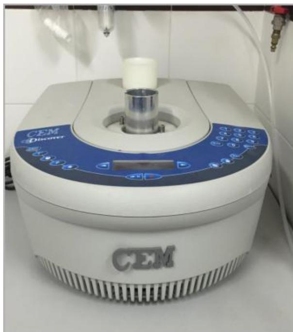
**Figura 5:** Micro-ondas focalizado Discover system (CEM)
