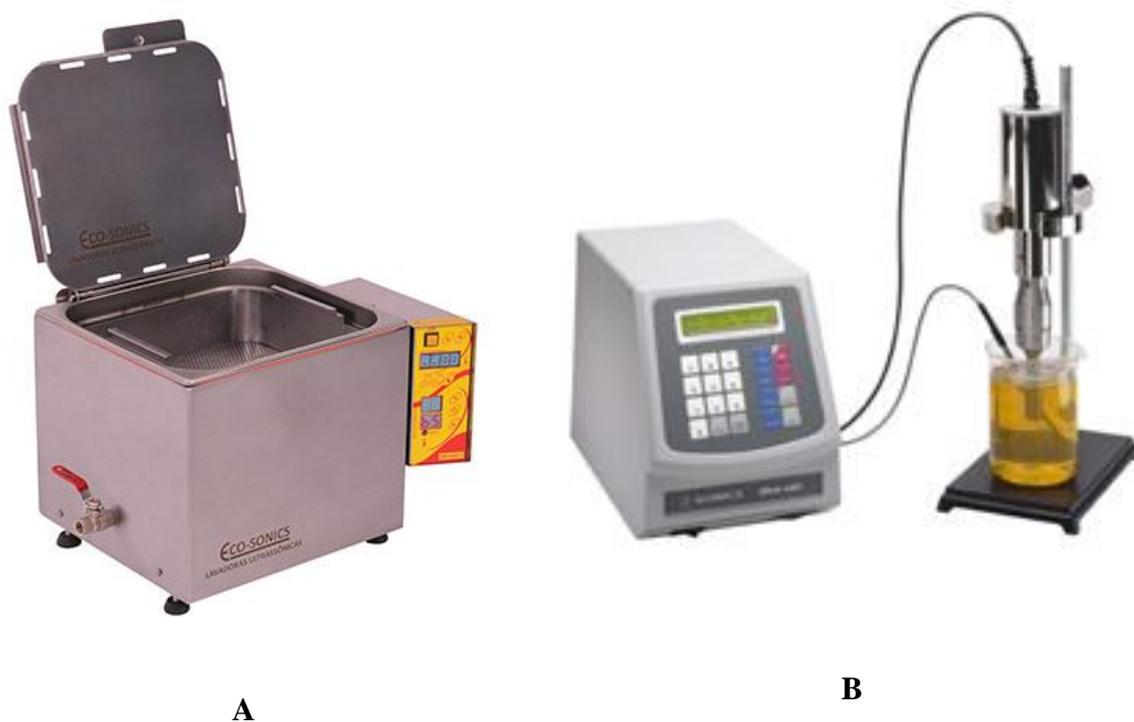
**Figura 7:** Tipos de ultrassom: A - Banho ultrassônico; B – Sonda de ultrassom
