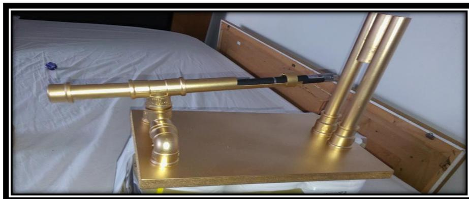
**Figura 6.6** – Microscópio Caseiro de PVC a laser
