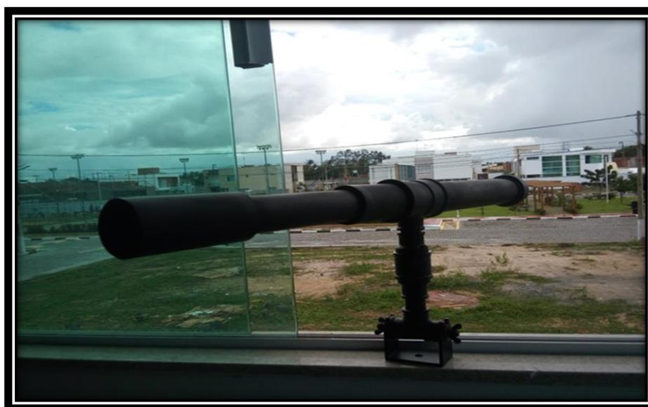
**Figura 6.13** – Luneta astronômica com ajuste auto azimuthal
