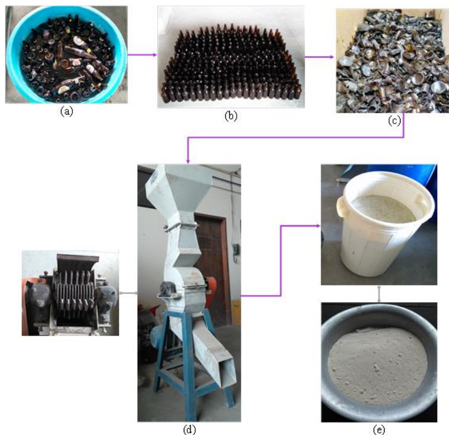
Figura 19 Aspectos do beneficiamento do RVG: (a) lavagem das garrafas; (b) garrafas após lavagem e secagem; (c) quebra das garrafas para trituração; (d) trituração no moinho de martelo; (e) RVG passante na peneira de 0,6 mm
