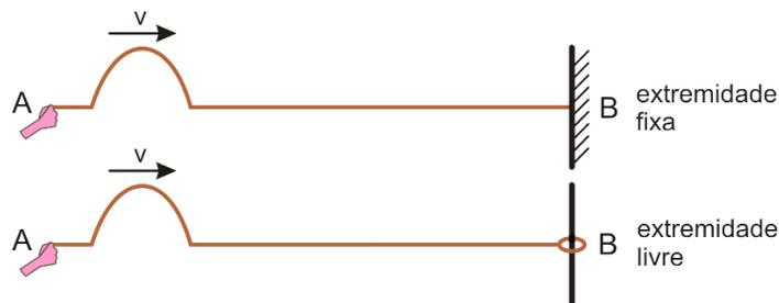
Figura 2-1 - Propagação de um pulso em um meio elástico, com fronteira fixa (sup.) e fronteira móvel (inf.).
